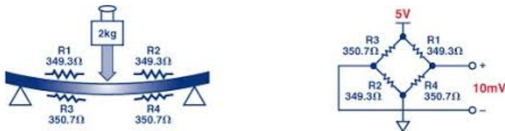
Figura 81. Funcionamiento del sensor de carga.
