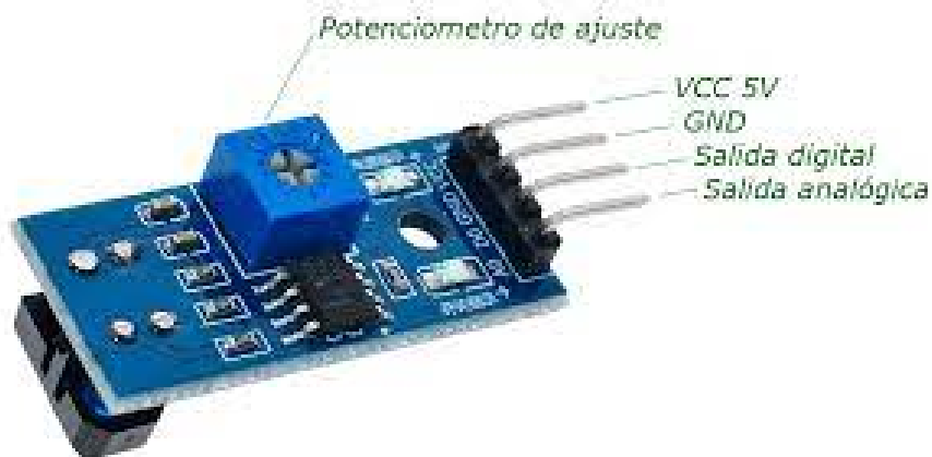
Figura 54. Partes de sensor seguidor TCRT 5000.
