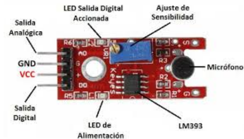
Figura 78. Partes del sensor KY-037
