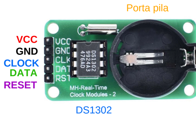
Figura 85. Partes del modulo RTC DS1302.
