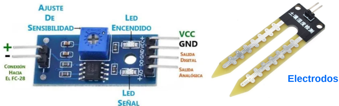
Figura 66. Partes del sensor FC-28.
