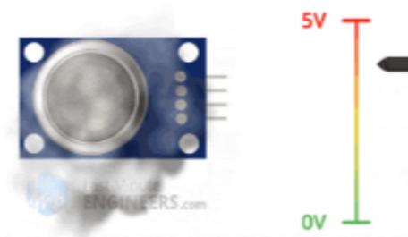
Figura 73. Funcionamiento del sensor MQ7.
