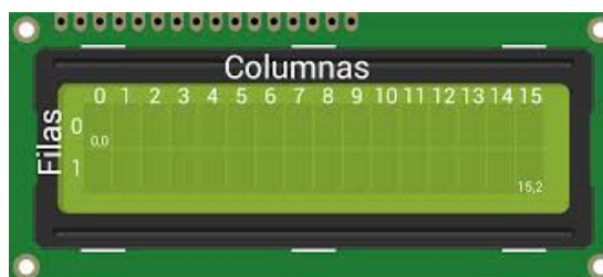
Figura 34. Funcionamiento del Display LCD (16x2)D con I2C.
